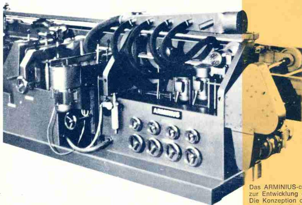
**Kanten-Falz- und Profilschleifmaschine
