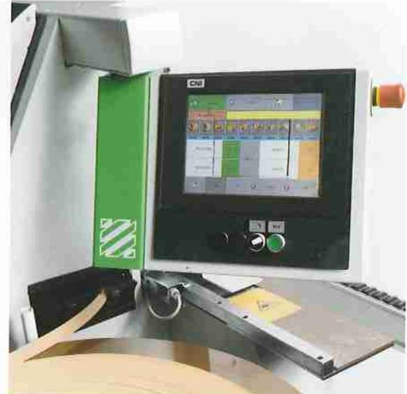
Contrôle Numérique TS06 avec écran LCD graphique couleurs de 6" touch screen. Il est possible, sur demande, de monter sur la machine Akron 400 TS10 de 10".
