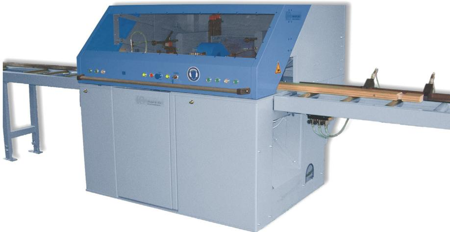
Blockhausfräse BL100 zum rationellen Erzeugen von Bauteilen für den modernen Blockhausbau. Die Bearbeitungen umfassen den Längenzuschnitt, das Fräsen der verschiedenen Verbindungen sowie das Herstellen von Bohrungen.
