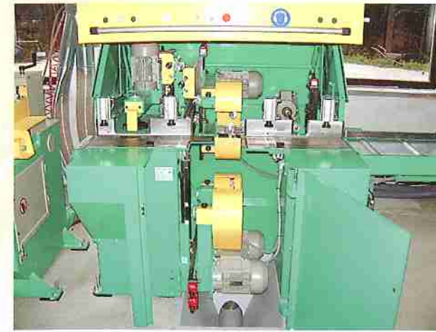
Die übersichtlich und kompakt angeordneten Bearbeitungs- aggregate sind durch die geöffnete Schutzhaube leicht zugänglich. The clearly arranged working units are for adjustment easy to reach with the open protective hood.
