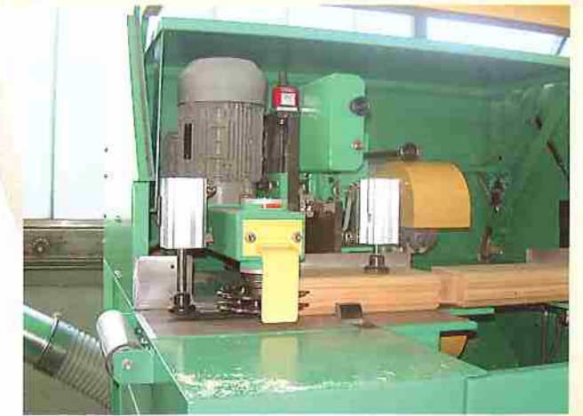
Stirnutaggregat zum Bearbeiten der Nuten für Tür- und Fensterleisten. Groove unit for working the grooves at doors and window frames.
