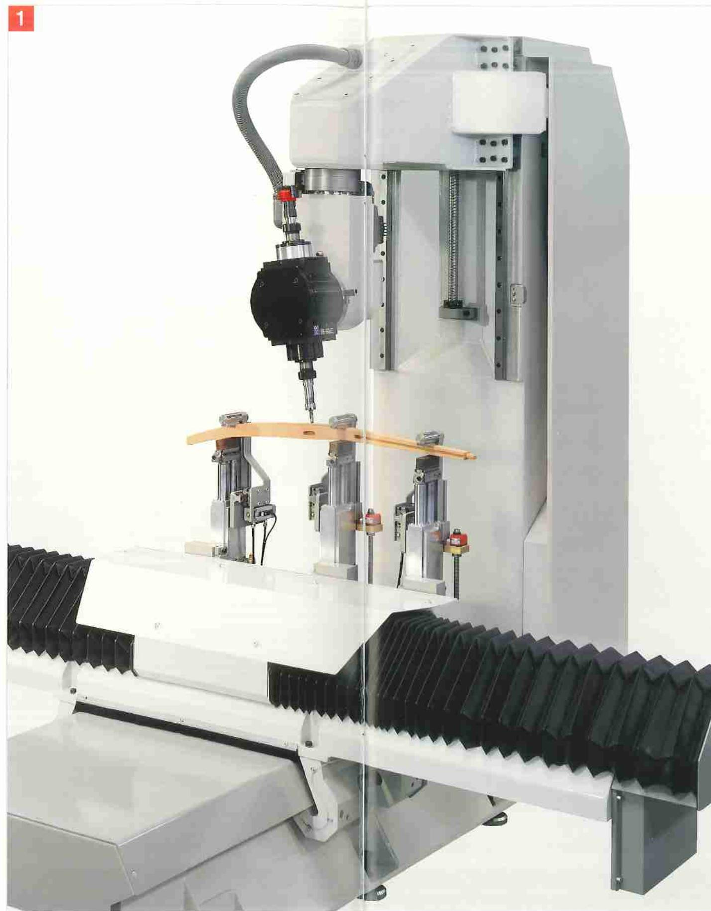
CNC Bearbeitungszentrum mit 5 interpolierten Achsen, digital, geeignet für:
