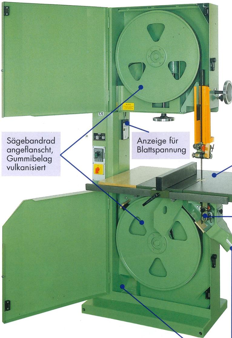
Sägebandrad angeflanscht, Gummibelag vulkanisiert
