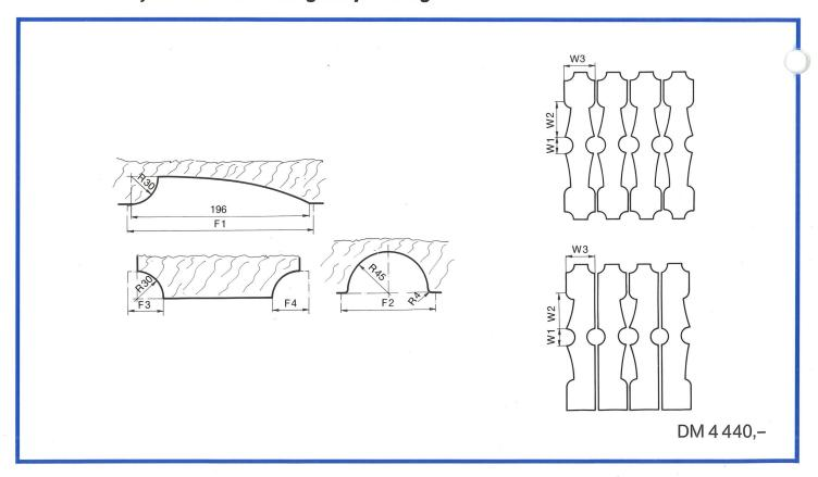
W1/W2/W3=1., 2. bzw. 3. Werkzeugaufspannung
