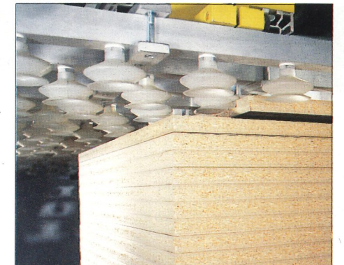
Abstreifwand zum Trennen der Werkstücke
