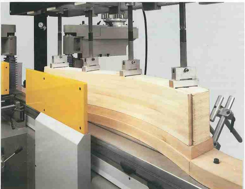
*Sulla robusta struttura della Junior sono montati di serie fresatori della potenza di 7,5 kW (10 HP) che permettono di fresare pezzi molto alti senza vibrazioni. In questa foto viene mostrato un particolare sistema di bloccaggio a depressione e pressori a bilanciere per la lavorazione di due pezzi in un unico passaggio.*
