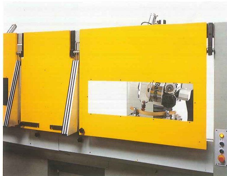
La lavorazione del pezzo avviene all'interno della macchina. Uno schermo, che viene chiuso automaticamente prima dell'inizio del ciclo e si riapre al termine, isola la zona di lavoro.
