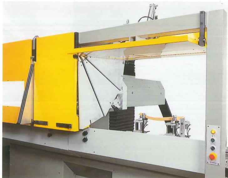
Con lo schermo di protezione aperto, l'operatore ha libero accesso al carico ed allo scarico dei pezzi, mentre la macchina sta lavorando sull'altro bancale. La zona di lavoro è comunque inaccessibile, grazie ad una carteratura mobile laterale, che protegge l'operatore da qualsiasi pericolo.
