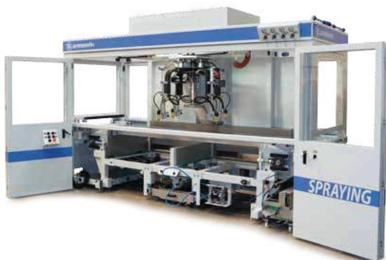
*Robot para barnizado de diseño compacto, con cabezal rotativo y alimentación de circuito único, cuatro brazos de trabajo, impulsado por motor con variador de frecuencia para la velocidad, desarrollado para la aplicación de pintura o barniz, con un ancho útil de trabajo de hasta 660 mm, velocidad de trabajo 6 m / min, con o sin pistolas y bomba de alimentación, provisto de PLC.*
