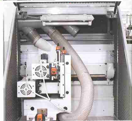
Double hogger. Double déchiqueteurs.
