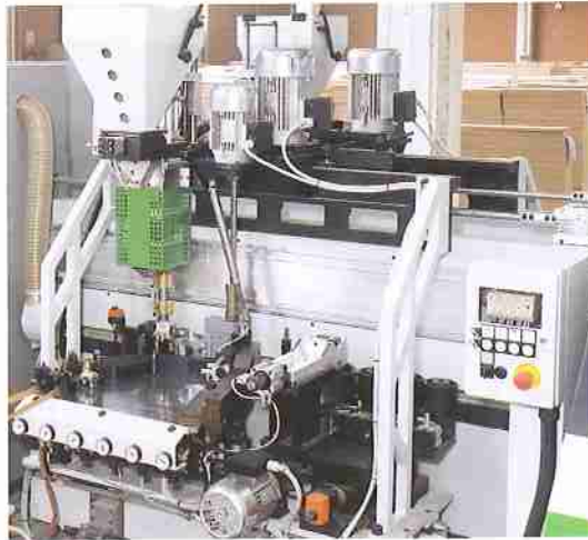
Edge-pressing unit. Zone de pression des chants.
