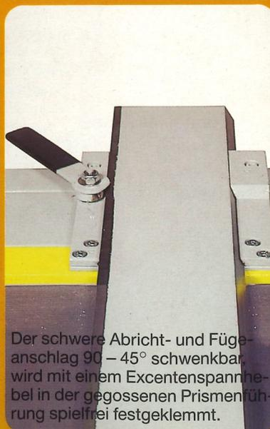
Der schwere Abricht- und Fügeanschlag 90 – 45° schwenkbar wird mit einem Excenterspannebel in der gegossenen Prismenführung spielfrei festgeklemmt.
