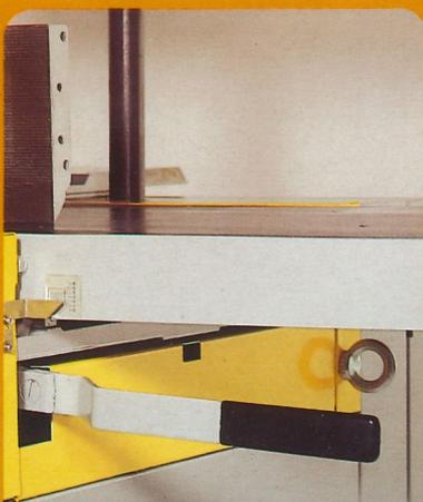
Müelos und schnell läßt sich der Aufnahmetisch auf die gewünschte Spanstärke einstellen. Der Handhebel zur Verstellung der Spanstärke ist gut positioniert.
