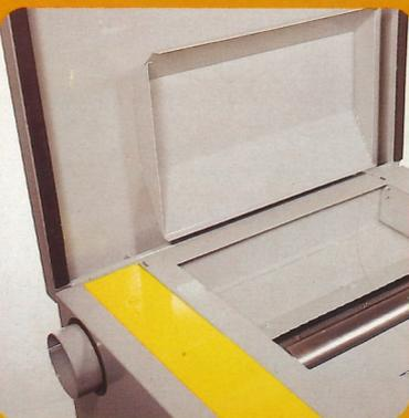
Bequem Zugang zur Messerwelle und zu den Vorschubwalzen durch einfaches Hochklappen der Haube. Das in der Haube angebrachte Spanleitblech garantiert für eine sichere und staubfreie Absaugung.
