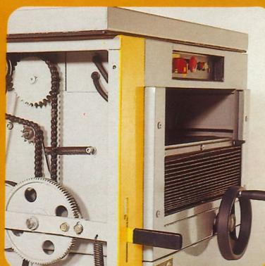
Das Vorschubgetriebe ist aus Sicherheitsgründen über Handhebel schnell auszuschalten. Der Faltenbalg zwischen Dickentisch und Maschinenständer sowie die rundum Stahlblech-Vollverkleidung verhindert eine Verschmutzung der Antriebsteile.
