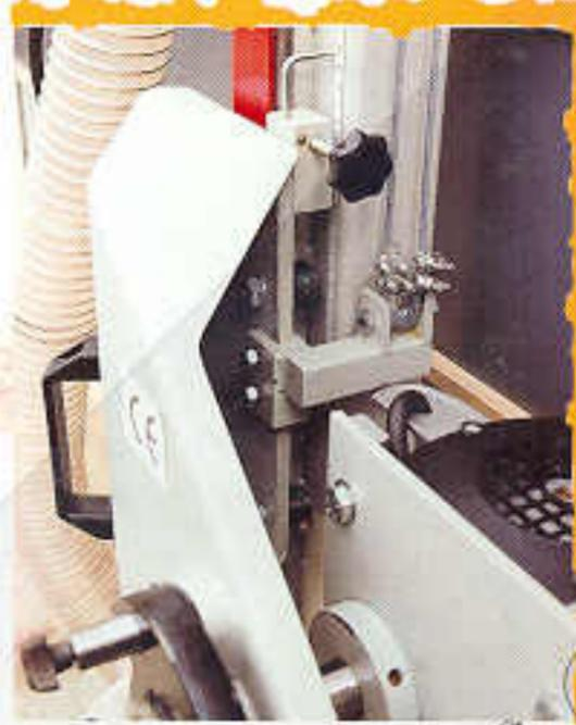
Das Herzstück der Maschine. Durch die exakte Führung auf dem Sägebalken können die Anforderungen kompromißlos erfüllt werden. Die Laufrollen aus hochvergütetem Stahl sind durch Exzenterbolzen nachstellbar. Eine spielfreie kompakte Verbindung von Sägeaggregat und Sägebalken ist durch diese Nachstellmöglichkeit noch nach Jahrzehnten gewährleistet.
