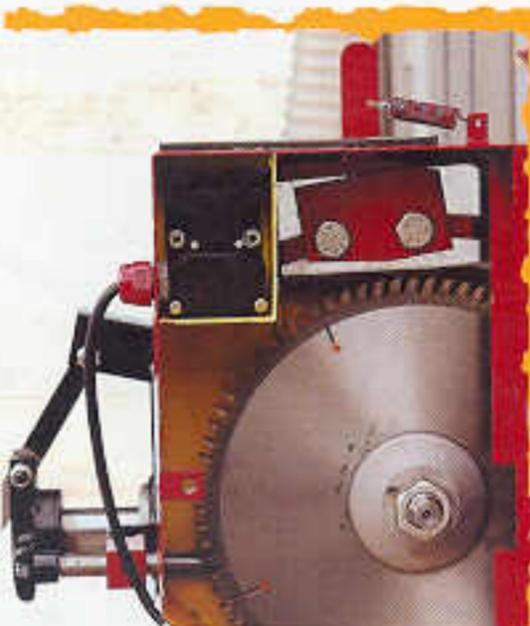
Alle Sicherheitsvorkehrungen sind getroffen. Nach dem Öffnen der Sägeblattabdeckung ist durch einen Sicherheitsschalter die Funktion des Motors blockiert (CE). Ein Sägeblattwechsel ist in wenigen Minuten problemlos möglich.
