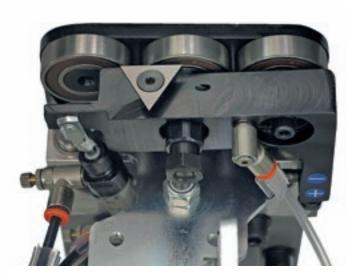
El **Grupo Rascador de Cola**, que retira la parte sobrante de cola en las partes superior e inferior del panel, es el único del mercado dotado de 4 cilindros neumáticos para conseguir una alta calidad de acabado.
