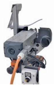
El **Grupo Fresador** permite realizar el ranurado y el fresado en la superficie inferior del panel.
