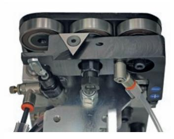
**Группа клеевого** скребка, которая удаляет избыток клея с верхней и нижней поверхностей панели, единственная на рынке, имеющая 4 пневмоцилиндра для высокого качества отделки.
