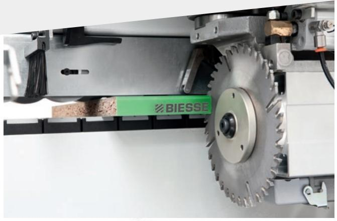
Надёжность и точность обрезки благодаря Торцевальной группе при удалении излишков кромки в начале и в конце панели. Торцевальная группа несёт в базовой конфигурации Систему Flex, позволяющую автоматически производить регулировку излишка кромки.
