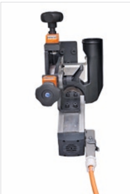
Das Bündigfräsaggregat verringert den Kantenüberstand am oberen Plattenteil.
