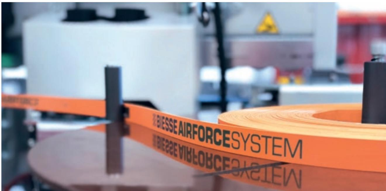
**Cargador automático mono rotor** que permite cambiar rápidamente el canto sin necesidad de abrir las cabinas. Sensor óptico para detectar el posicionamiento correcto de la placa (opcional).
