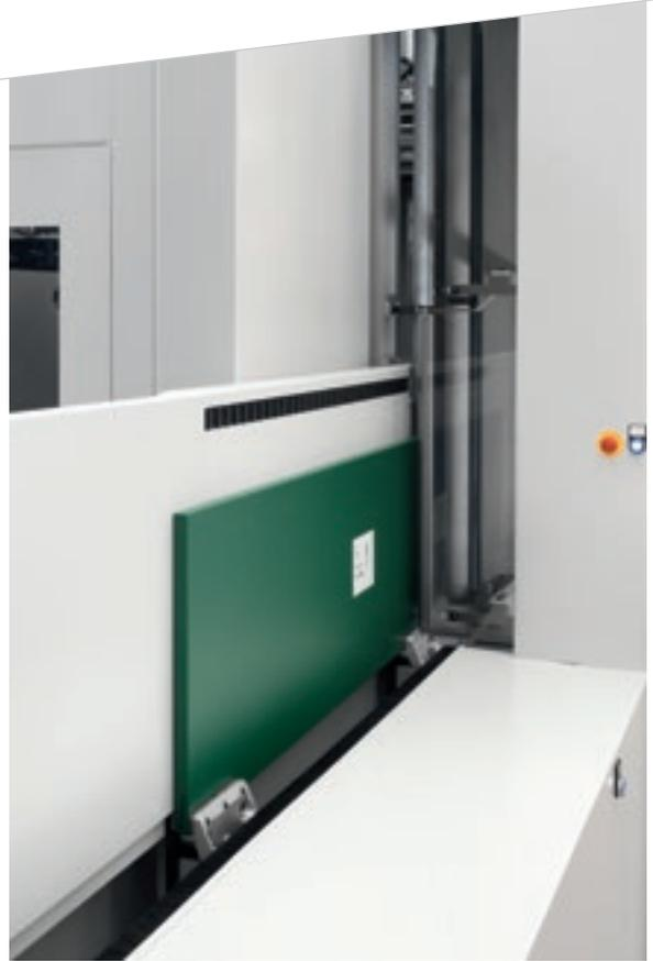
**Захваты**, кроме того, имеют систему считывания толщины панели, которая позволяет изменять в реальном времени программное значение, обеспечивая точность обработки по оси "Z".
