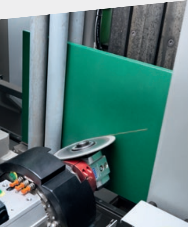
Pantographfräsmaschine mit integrierter C-Achse (Option).
