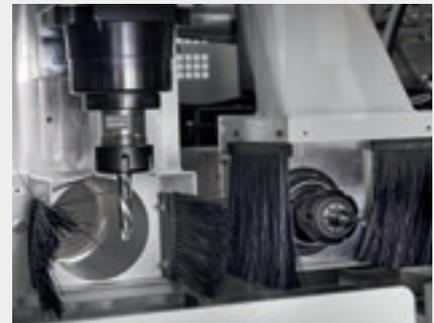
La máquina puede equiparse con unidades de fresado horizontales y verticales para realizar operaciones de mecanizado especiales, como escalado, cajas, ranuras y mecanizado para el Lamello Clamex.
