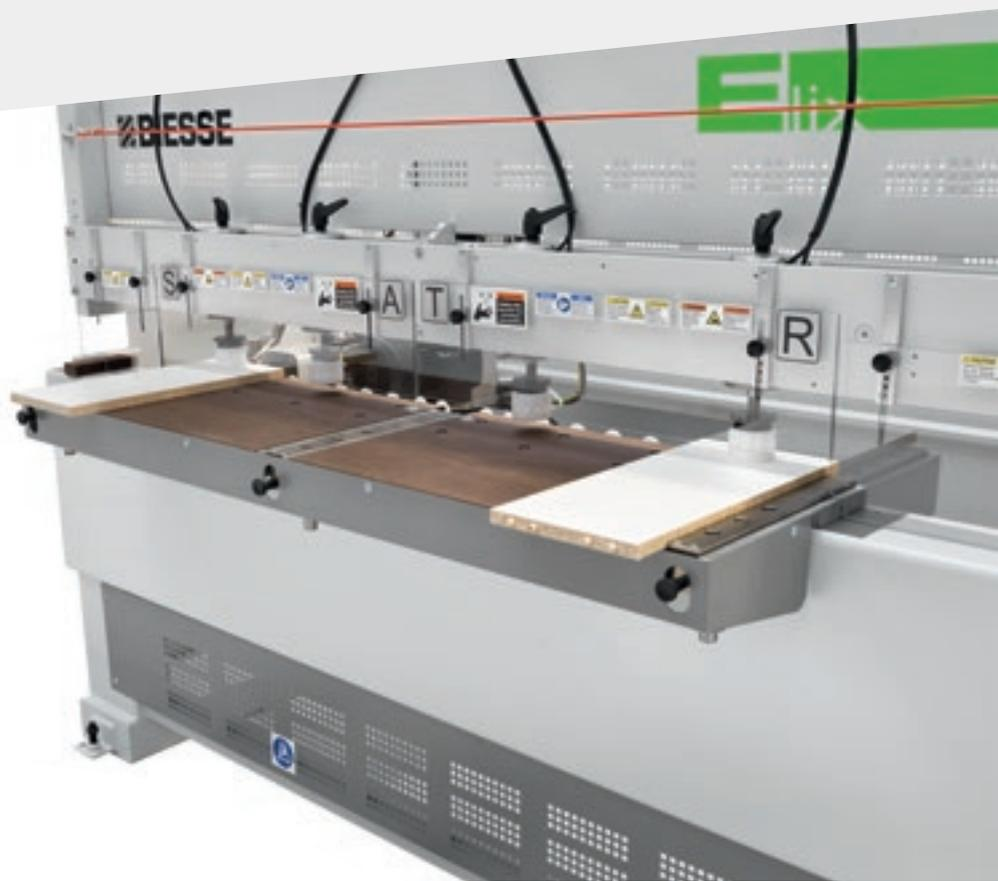
Elix dispone de dos superficies de trabajo independientes, lo que permite mecanizar los paneles en los orígenes contrarios de forma alternada y, por tanto, realizar las operaciones de carga y descarga mientras la máquina está en marcha.
