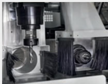
La macchina si può equipaggiare con unità di fresatura orizzontale e verticale per eseguire lavorazioni particolari di scanature, tasche, slot e lavorazioni per il lamello Clamex.
