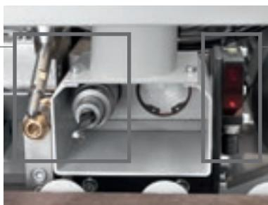
Elix è dotata di serie di un **sistema di lettura laser** della lunghezza del pannello che in funzione della misura reale del pannello può correggere in modo automatico le quote di lavoro, garantendo un assemblaggio perfetto del box.
