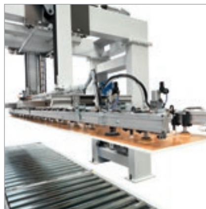
La personnalisation de la machine avec châssis à ventouses permet l'usinage de barres à découper.
