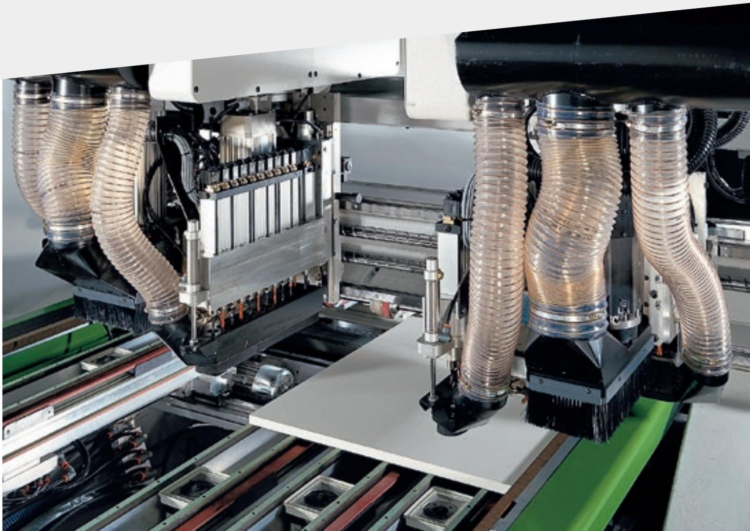
La presenza di **due coppie di teste operatrici** montate su due carri mobili indipendenti rende possibile l'esecuzione delle operazioni di foratura più complesse in tempi estremamente rapidi, anche dovendo lavorare pezzi diversi l'uno dall'altro.
