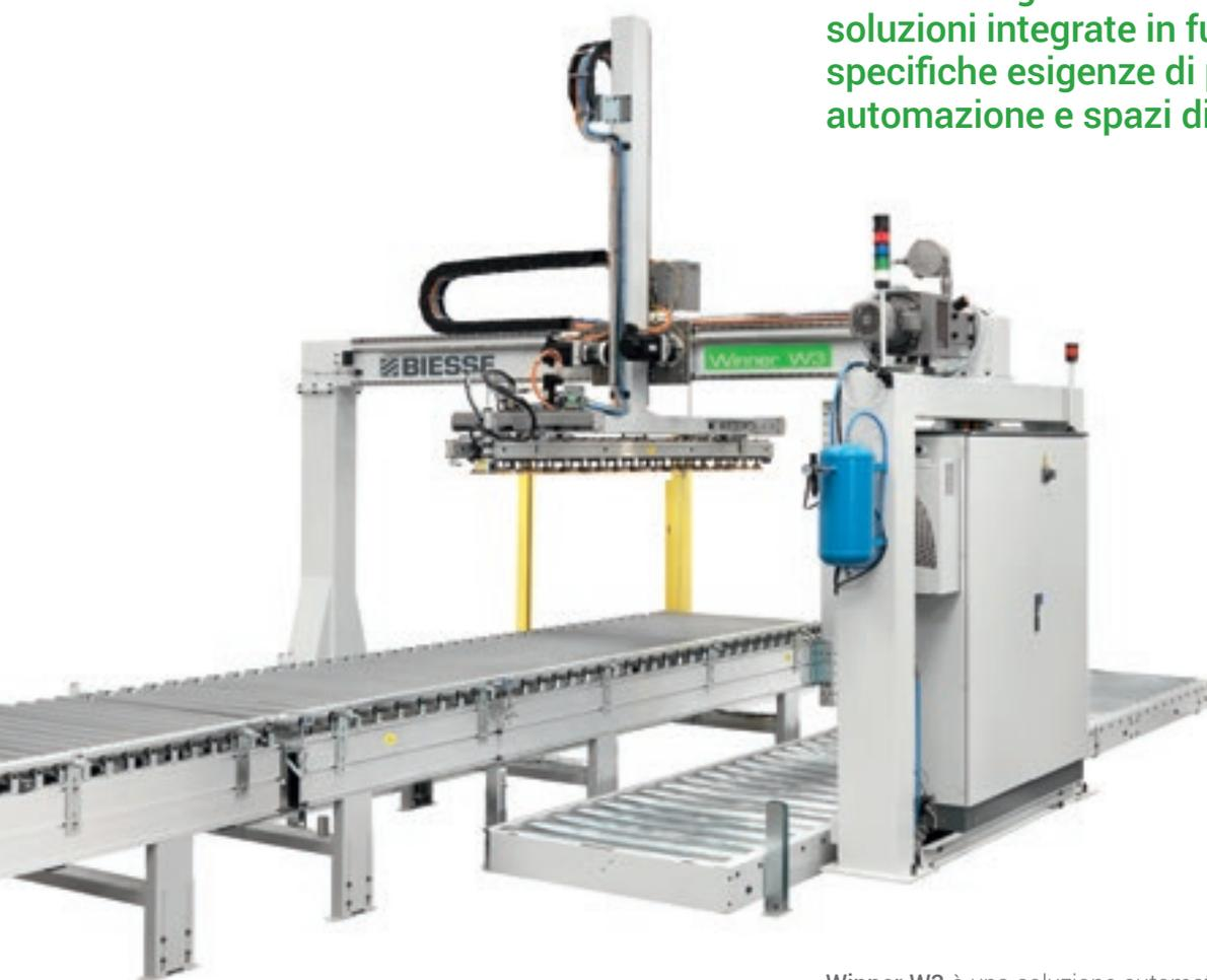
Winner W3 è una soluzione automatica che consente il carico e scarico di pannelli in linee flessibili di foratura per la gestione di pile a commessa.
