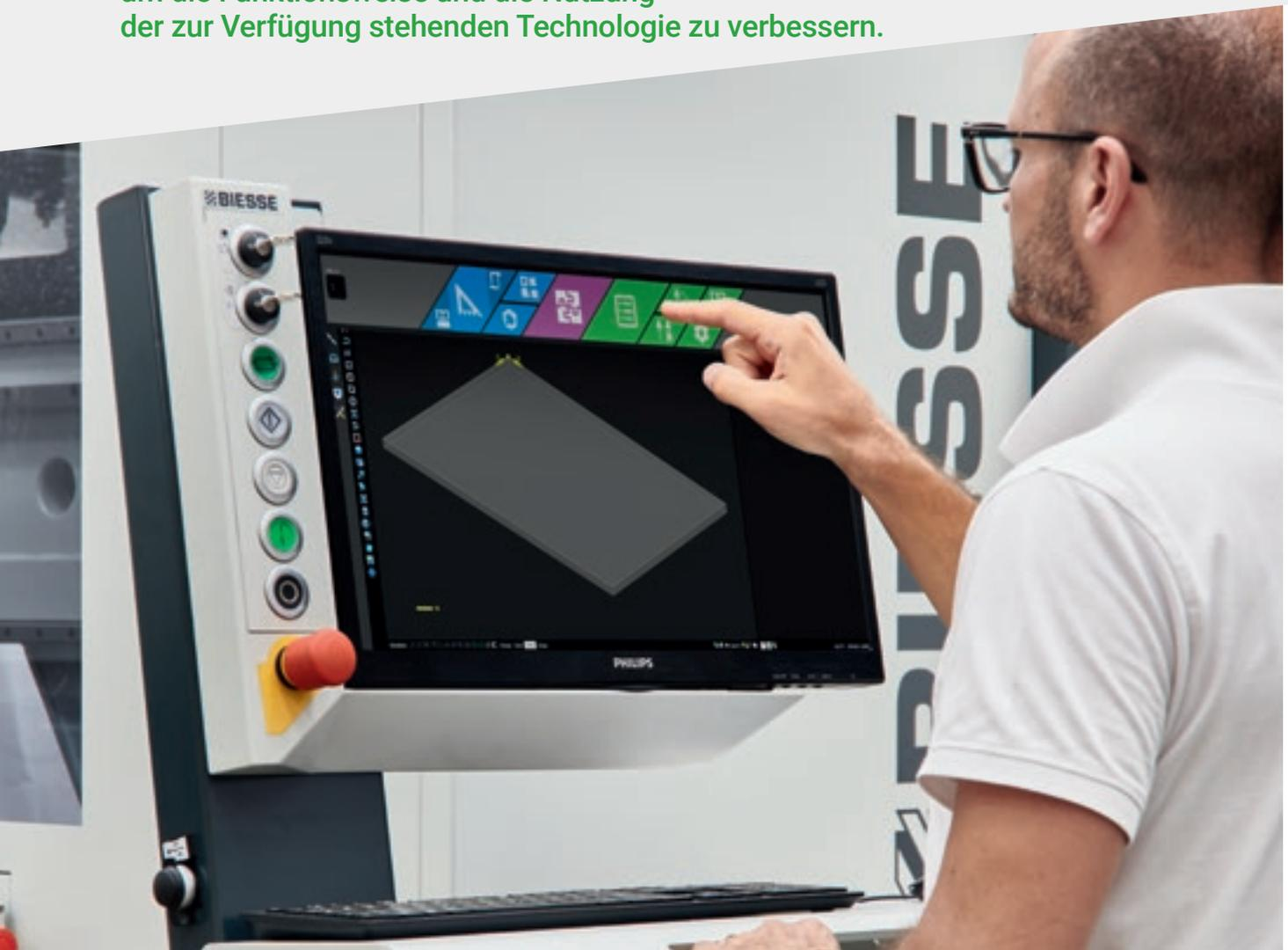
**bTouch ist der neue 21,5"-Touchscreen mit dem sich alle von der Maus und der Tastatur ausgeübten Funktionen ausführen lassen, im Sinne einer direkten Interaktivität zwischen Benutzer und Gerät.**
