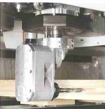
Scasso per serratura Schlosskasten
