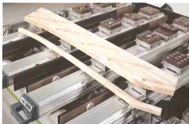
Lavorazione del montante laterale e del corrimano Bearbeitung der seitlichen Treppenwange und Handlauf
