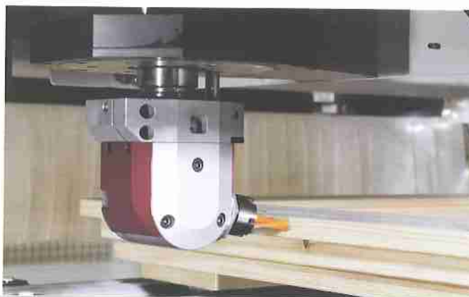
Foratura inclinata per anube. Bohren für Anuba-Bänder
