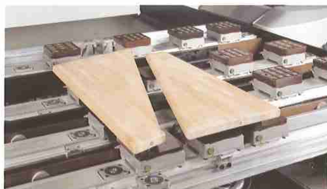
Lavorazione del gradino Bearbeitung der Stufe
