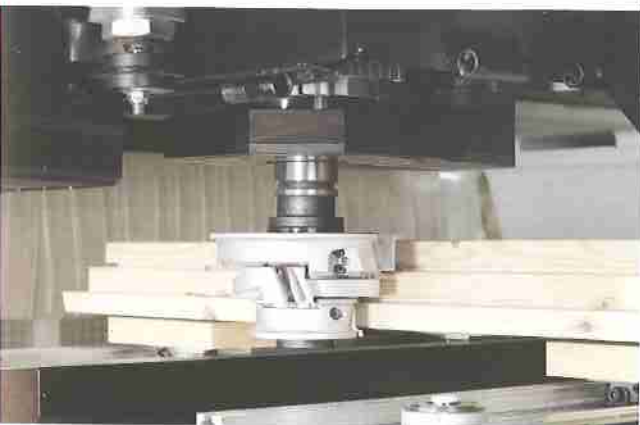
Sbattentatura Formfräsen von Türen und Fenster
