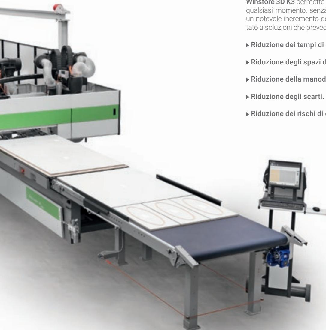
**Winstore 3D K3** permette di disporre del pannello da lavorare in qualsiasi momento, senza frequenti cambi pila determinando un notevole incremento della produttività della cella se rapportato a soluzioni che prevedono il carico di pile tramite muletto.
