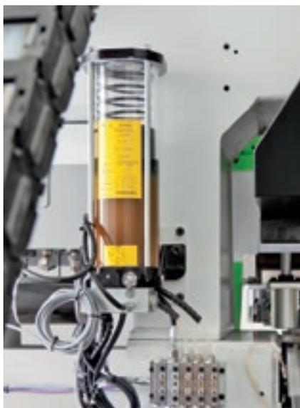
La **lubrification automatique** garantit une lubrification continue des principaux organes d'actionnement de la machine sans l'intervention de l'opérateur.
