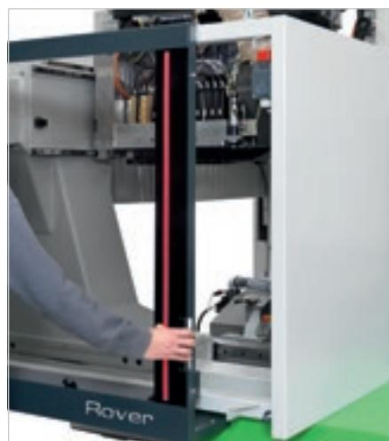
加工单元的全方位保护，宽敞的侧开门设置提高了加工操作的可视化程度，同时也能确保操作员可以轻松进入加工区域。
