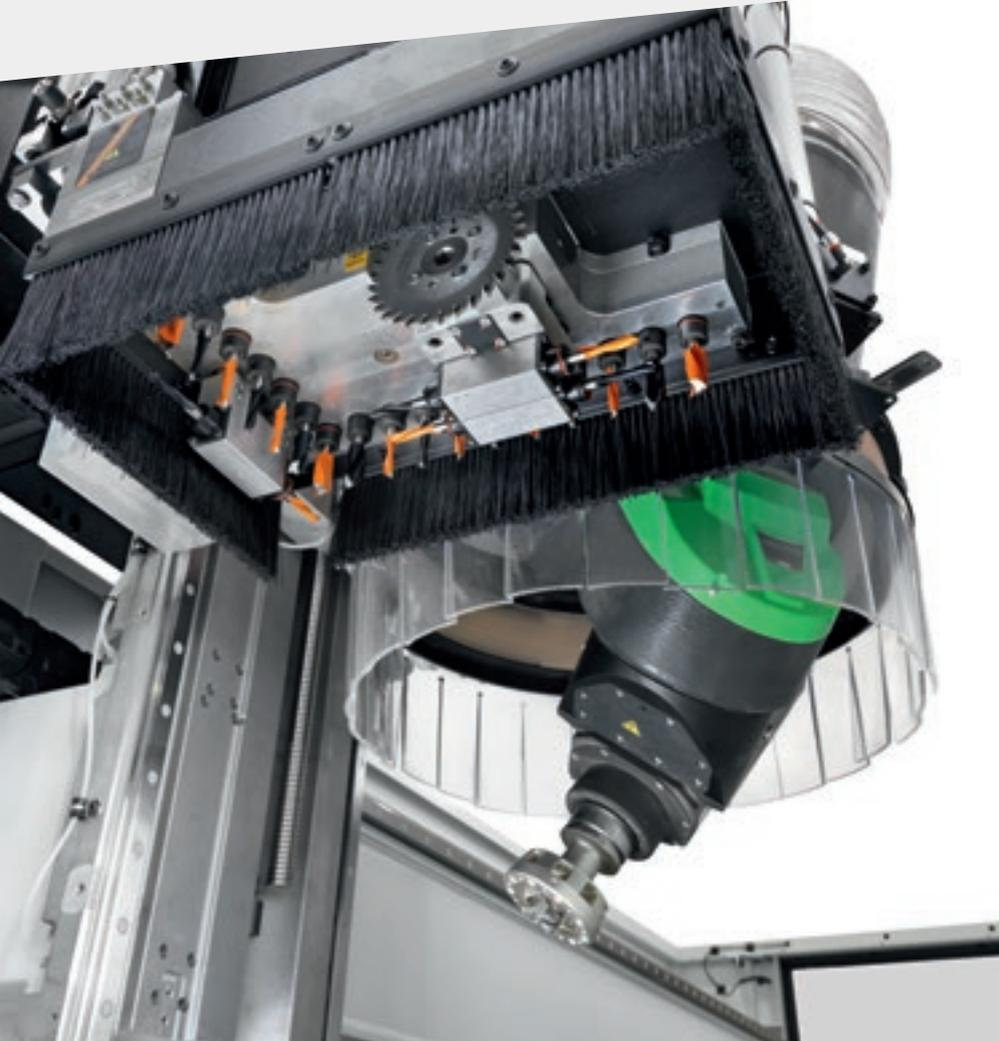
ROVER A SMART FT配备的都是高科技元件。电子主轴、钻盒和组合刀具由全球机电一体化行业的领导者HSD公司为比雅斯设计制造。
