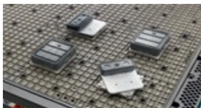
Módulos de vacío que se pueden colocar libremente en la plataforma de trabajo FT sin necesidad de conexiones específicas.
