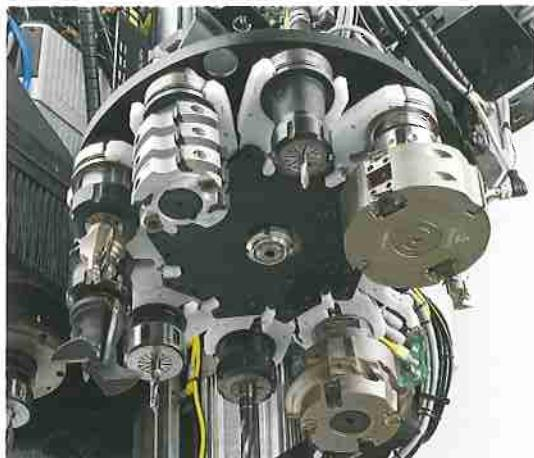
Der auf dem Z-Achsenträger montierte Revolverwerkzeugwechsler ermöglicht das Wechseln von Werkzeugen und Aggregaten, während die Maschine andere Operationen ausführt.
