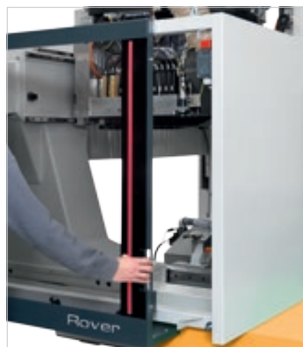
Protección integral del grupo operador. La gran puerta garantiza la máxima visibilidad de trabajo y facilidad de acceso a grupos de operadores.
