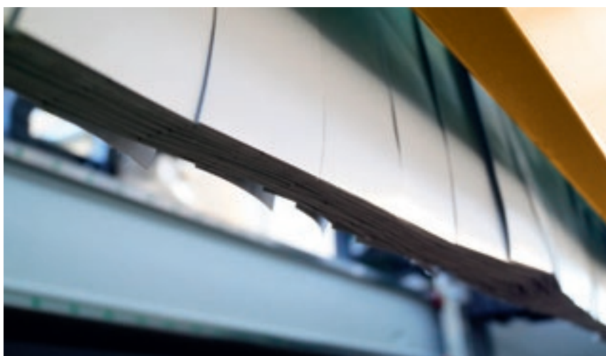
Capas superpuestas de flejes laterales para proteger el grupo operador.
