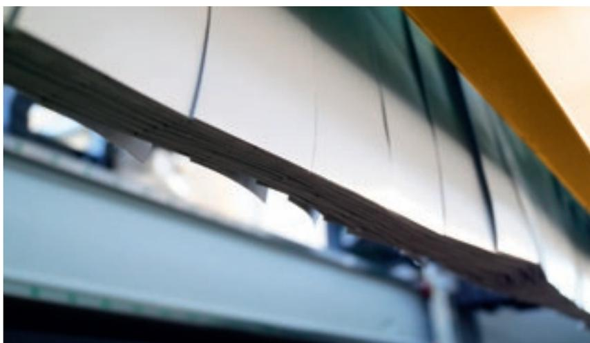
Strati sovrapposti di bandelle laterali a protezione del gruppo operatore.
