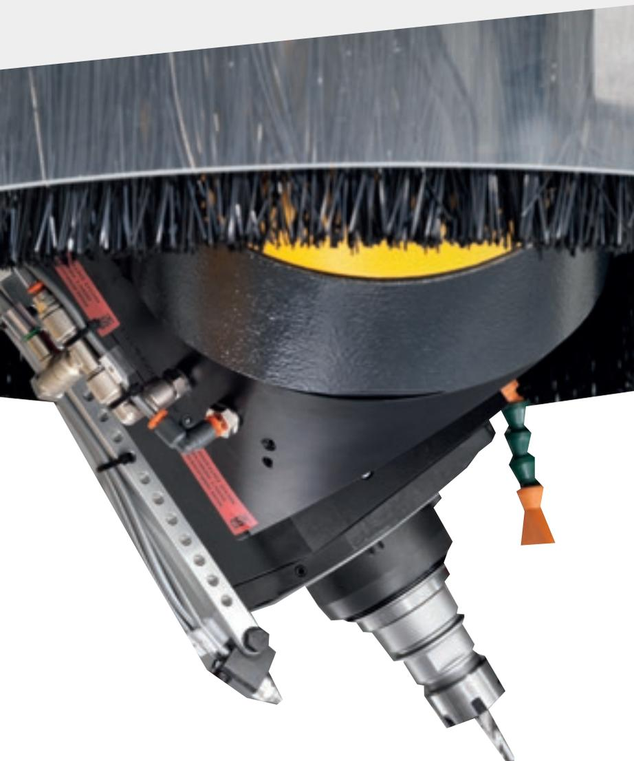
Rover Plast A SMART FT monta gli stessi componenti utilizzati sugli altri modelli di alta gamma. L'elettromandrino è progettato e realizzato per Biesse da HSD, azienda leader mondiale nel settore.
