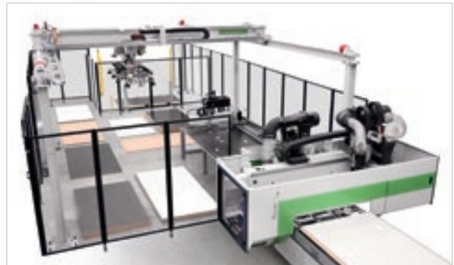
**Winstore** permette di disporre del pannello da lavorare in qualsiasi momento, senza frequenti cambi pila determinando un notevole incremento della produttività della cella se rapportato a soluzioni che prevedono il carico di pile tramite muletto.
