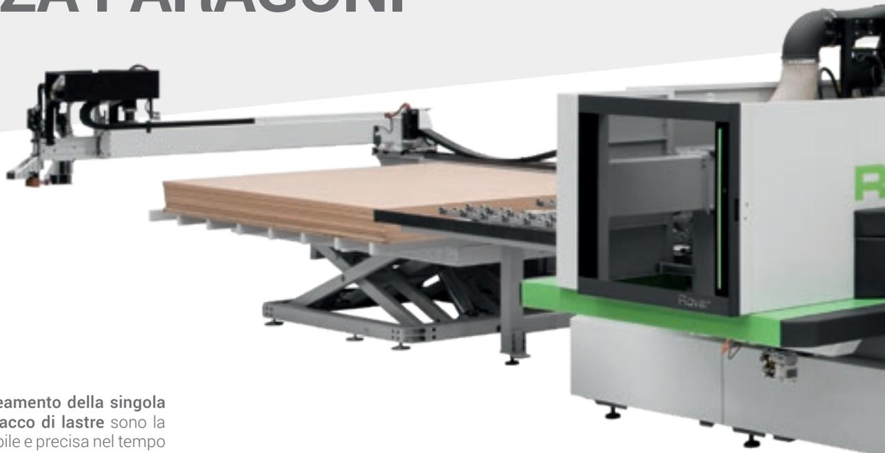
I rulli per l'allineamento della singola lastra o di un pacco di lastre sono la soluzione affidabile e precisa nel tempo senza precedenti.
