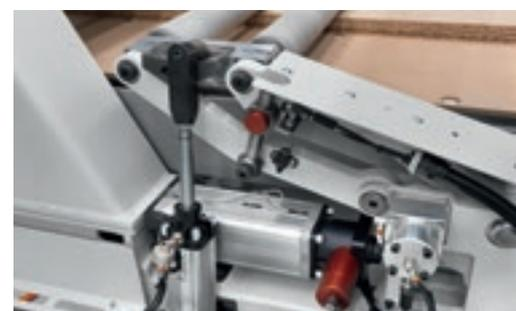
Il **pressatore a rulli** consente di lavorare fino a 3 pannelli per fusti di salotto e in generale applicazioni con lastre di materiale traspirante sovrapposte. Sistema estremamente efficace anche per la lavorazione su lastre di sottoformati con larghezza molto inferiore alla copertura dei rulli.
