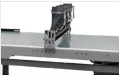
**Sistema da 2 a 4 cappe di aspirazione** posizionato sopra il tappeto di scarico.
