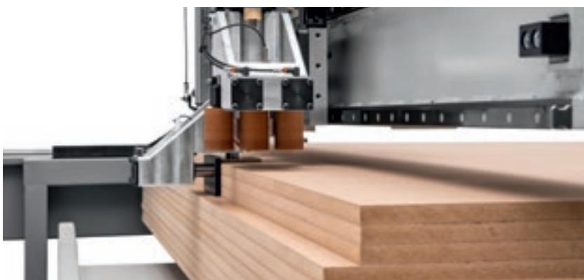
Il **sistema di spinta** a controllo numerico di un pacco di lastre introduce una flessibilità di carico completamente innovativa.
