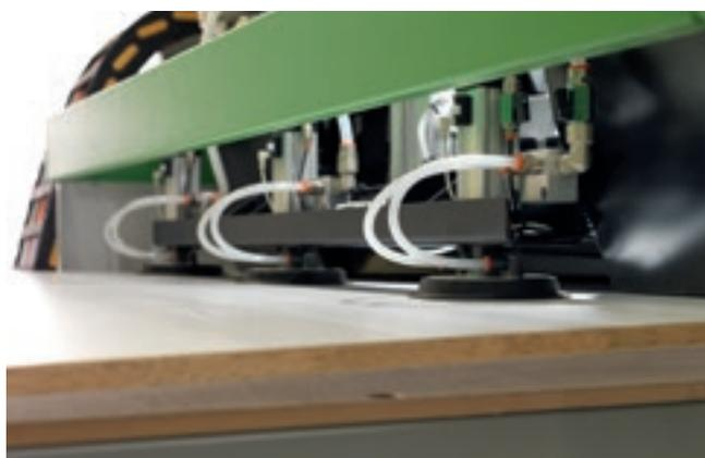
La tecnologia delle ventose di carico indipendenti e con sistemi di distacco forniscono una flessibilità al carico unica sul mercato.
