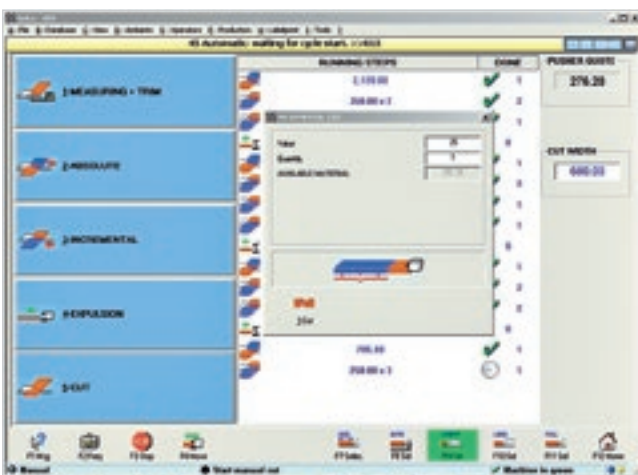
Interaktives Programm für die einfache und schnelle Ausführung von Schnitten und Nuten auch bei Rest-Platten.
