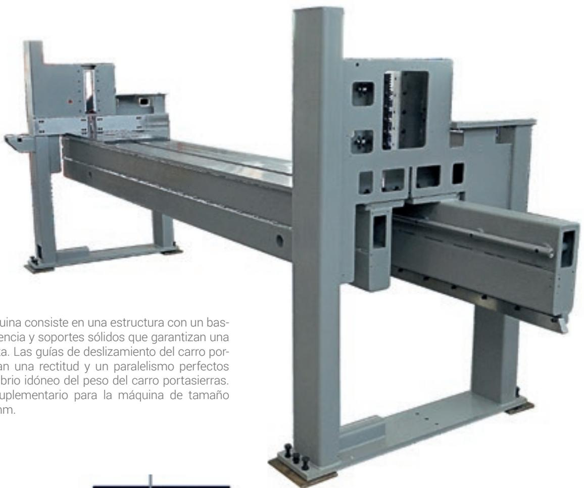
La base de la máquina consiste en una estructura con un bastidor de alta resistencia y soportes sólidos que garantizan una estabilidad perfecta. Las guías de deslizamiento del carro portasierras garantizan una rectitud y un paralelismo perfectos así como un equilibrio idóneo del peso del carro portasierras. Soporte central suplementario para la máquina de tamaño 3800mm x 3800mm.
