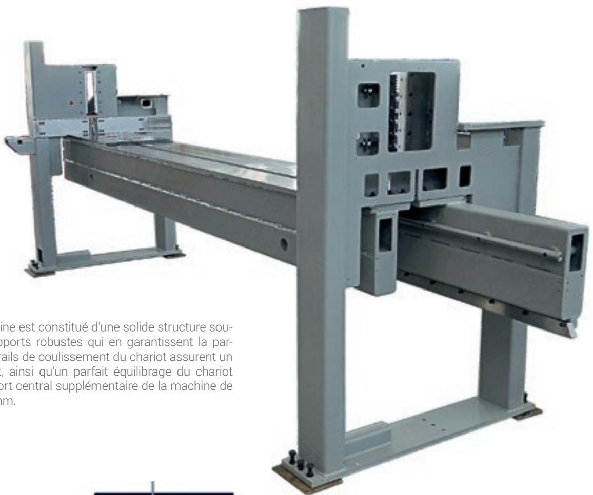
Le bâti de la machine est constitué d'une solide structure soutenue par des supports robustes qui en garantissent la parfaite stabilité. Les rails de coulissement du chariot assurent un alignement parfait, ainsi qu'un parfait équilibrage du chariot porte-outils. Support central supplémentaire de la machine de 3800mm x 3800mm.
