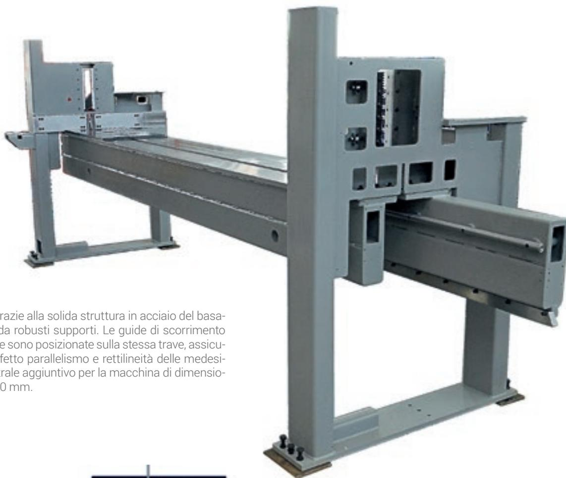
Perfetta stabilità grazie alla solida struttura in acciaio del basamento sostenuta da robusti supporti. Le guide di scorrimento del carro portalamme sono posizionate sulla stessa trave, assicurando quindi il perfetto parallelismo e rettilineità delle medesime. Supporto centrale aggiuntivo per la macchina di dimensioni 3800 mm x 3800 mm.
