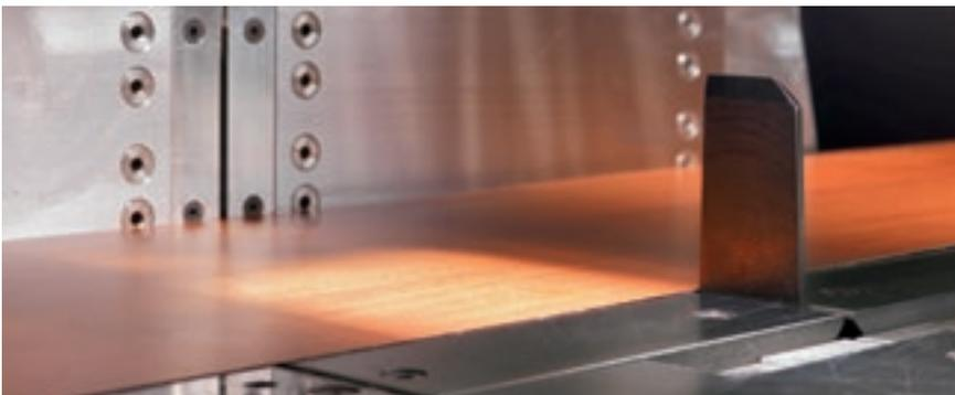
Perfetto allineamento anche di pannelli sottilissimi e/o flessibili riducendo al minimo il tempo di ciclo grazie alla **battuta di allineamento laterale** integrata nel carro lama.
