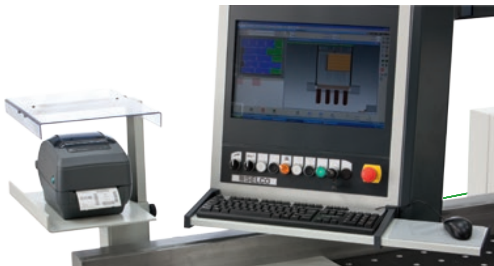
Barcode scanner Dispositivo per il richiamo automatico degli schemi di lavorazione per l'automatizzazione e la gestione dei resti di sezionatura riutilizzabili.
