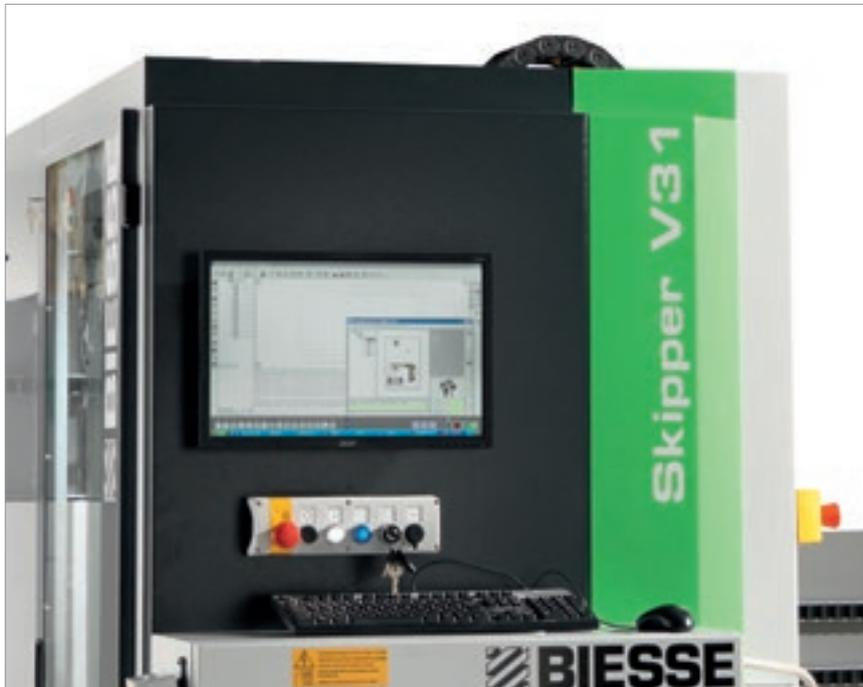
La macchina comandata da un PC è dotata di una moderna interfaccia software che ne rende particolarmente semplice ed intuitiva la programmazione.
