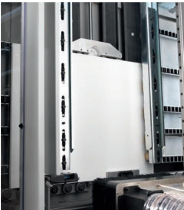
I rulli pressore ed il dispositivo di pressione verticale garantiscono la massima tenuta del pannello.
