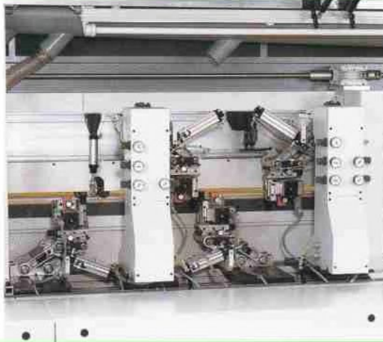
Four motor corner-rounding unit with quick change. Arrondisseur à quatre moteurs à changement rapide.
