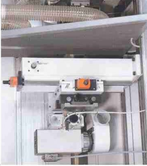
Universal milling unit with pneumatic jump, 0-90° rotatable. Toupe universelle à intervention pneumatique, pivotante 0-90°.
