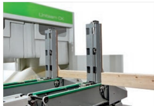
**Буфер**, представляющий собой цепи с электроприводом, на которых возможно размещение деталей, позволяет автоматически непрерывно подавать их в станок без потери времени.
