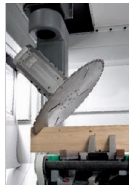
**Фрезеровальная голова с 5 осями** мощностью 17 кВт, способная выдерживать обработки с помощью очень больших и тяжёлых инструментов благодаря энкодеру, позиционируемому на оси шпинделя в целях контроля потребления тока в зависимости от скорости подачи инструмента.
