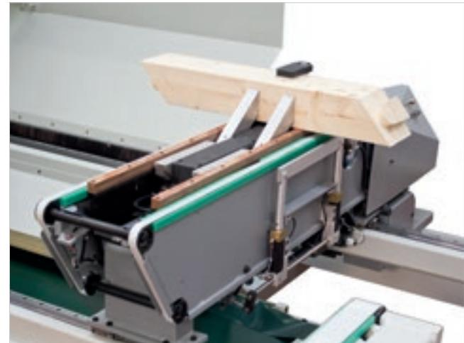
**Система подачи брусьев** представляет собой четыре картеки с гидравлической вертикальной и горизонтальной фиксацией.
