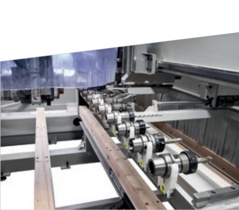
Werkzeugmagazin mit 10 Plätzen für einen schnellen Werkzeugwechsel.
