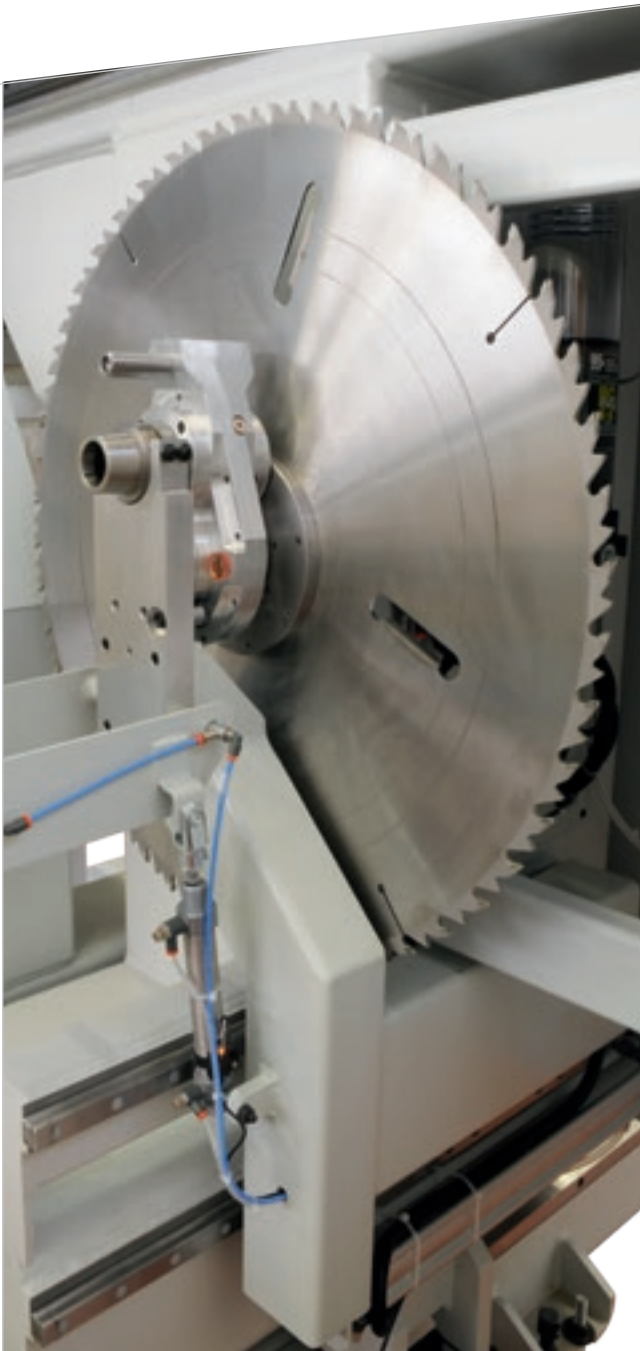
Sägeblattmagazin mit 850 mm Durchmesser.
