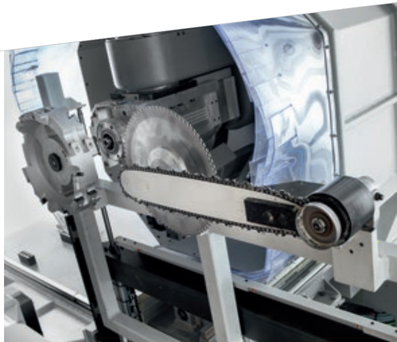
Magazzino 3 posizioni per utensili di grandi dimensioni, compreso utensile catena se necessario.
