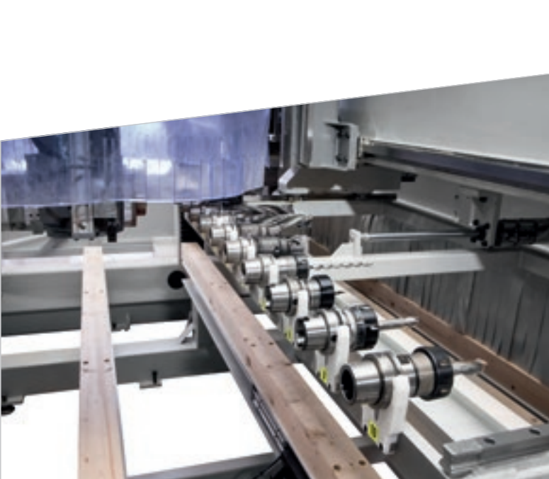
Magazzino utensili 10 posti per un rapido cambio utensile.
