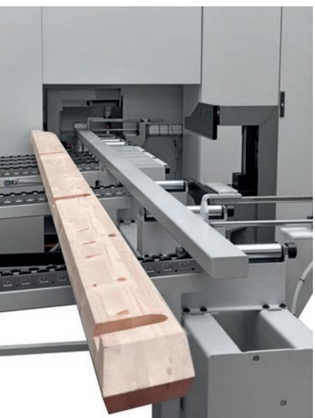
El desplazamiento de la pieza se ha estudiado para garantizar el máximo agarre y una altísima calidad de mecanizado.
