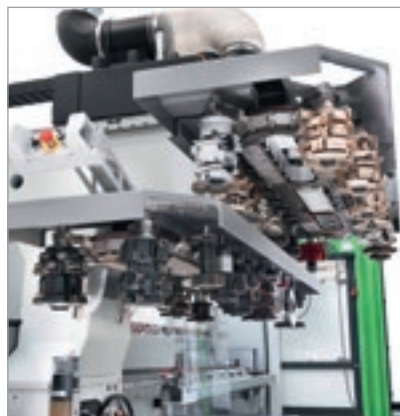
Almacén flexstore con 44, 66 y 88 posiciones con entreeje de 180 mm.
