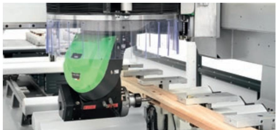
**Tête à 5 axes** de 16,5 kW orientée vers le matériau massif : puissance et rigidité pour réaliser des enlèvements importants.
