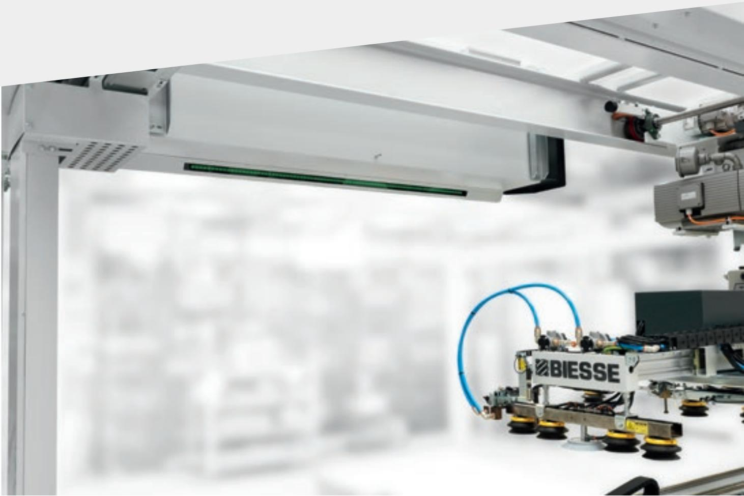
Con la barra de LEDs, que indica el estado de la máquina visible desde cualquier posición, el operador puede controlarla mejor en cualquier momento.
