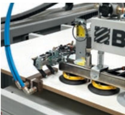
Dispositivo de chorro de aire dedicado para el desprendimiento de materiales transpirables, ajuste automático del chorro en dos gamas de espesor del material para aumentar la eficiencia del desprendimiento y la productividad de la máquina.
