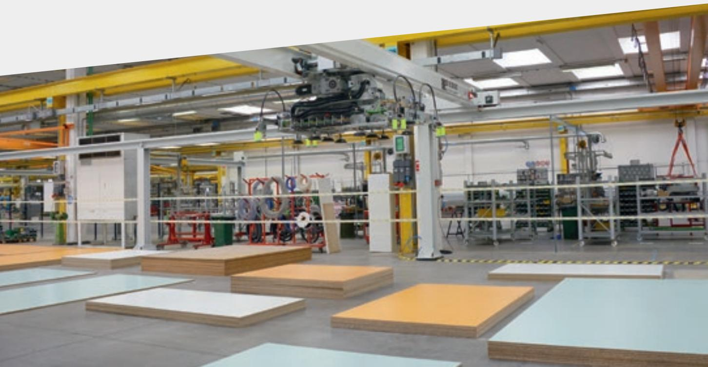
Winstore prepara las pilas de los paneles de varios formatos y tipos, incluso mixtas, sin necesidad de operarios. La reorganización del almacén de los paneles y la preparación de las pilas se lleva a cabo de forma automática, incluso fuera del horario laboral.
