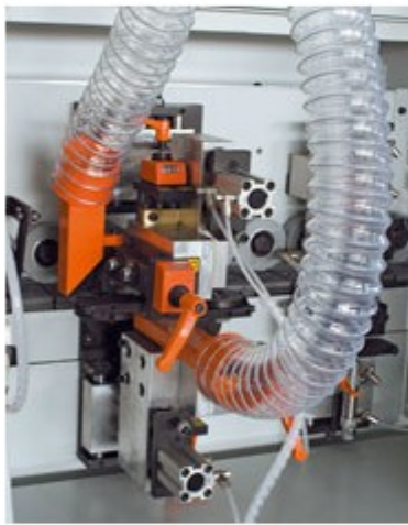
Ziehklingenaggregat mit Flüssigtrennmittel- Sprüheinheit.
