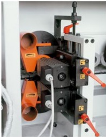
Überlagertes Bündigfräsaggregat HF 12.000 U/min.
