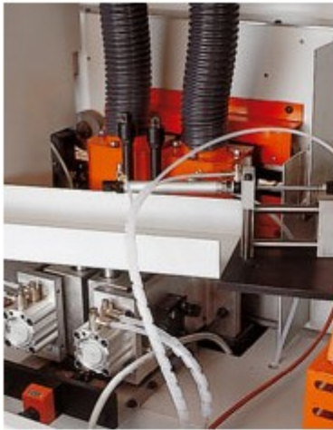
Fügefräsaggregat HF mit 2 Motoren mit 12.000 U/min.
