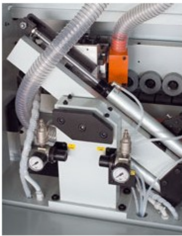
Senkrechtes Kappaggregat mit 2 Motoren zu 12.000 U/min., schwenkbar von 0° bis 15°.
