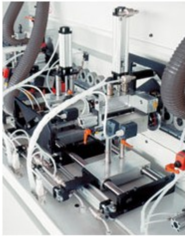
Abrundaggregat ARC 03 mit 2 Motoren HF 18.000 U/min, zur Bearbeitung der Front.
