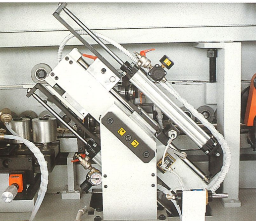
INTESTATORE VERTICALE - Con 2 motori da HP 0,4 a 12.000 g/l'. - Con copiatori frontali e laterali. - I motori sono inclinabili da 0° a circa 15°.
